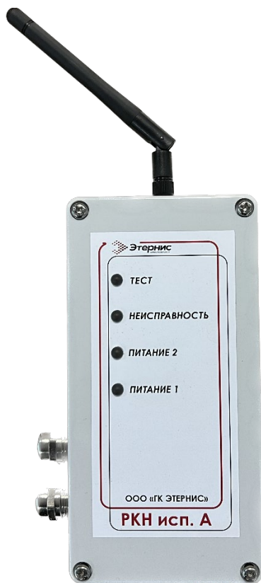
Рис. 1. Внешний вид радио контроллера направления (РКН) исп. А.
